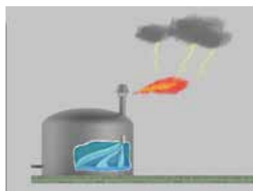
图4 工业阻火器较早的应用于石油储罐泄放口
