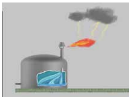
图8 非局限火焰燃爆原理
