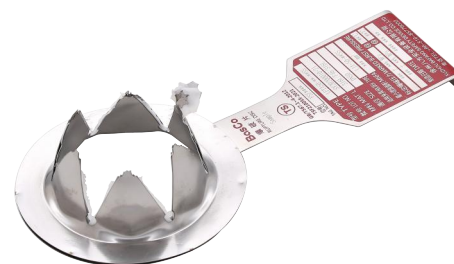
LF爆破片爆破后
